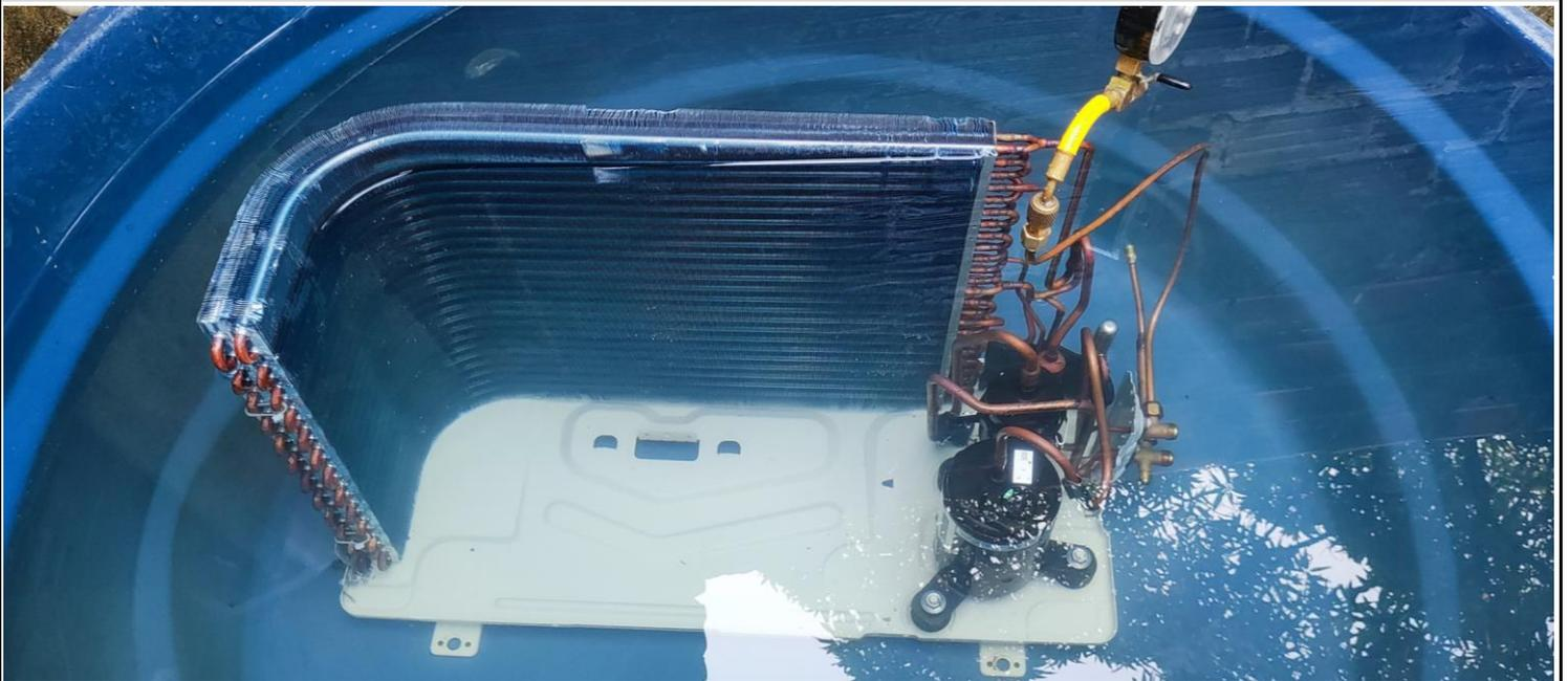
FOTO 02: TESTE DE ESTANQUEIDADE SUBMERSO UNIDADE CONDENSADORA.
