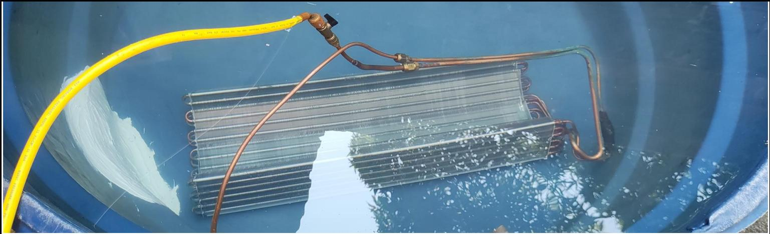
FOTO 01: EXECUTANDO TESTE SUBMERSO NA SERPENTINA DA UNIDADE EVAPORADORA.
