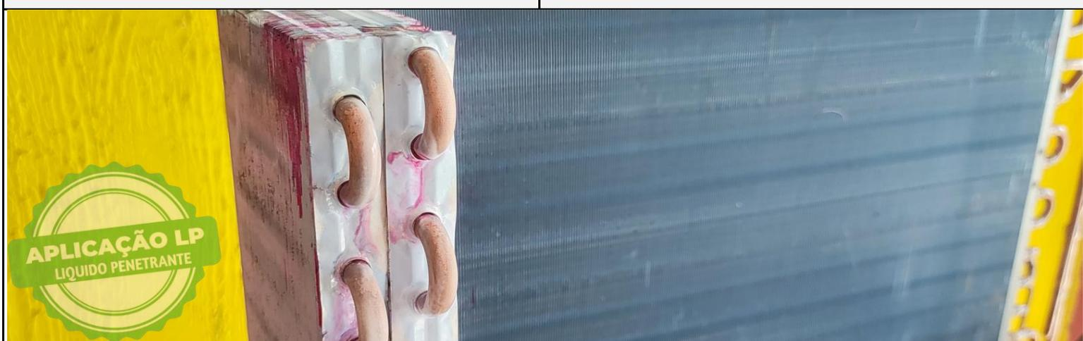
FOTO 04: APÓS APLICAÇÃO DO D70, REALIZAR INSPEÇÃO PARA VERIFICAÇÃO DE TRINCAS.
