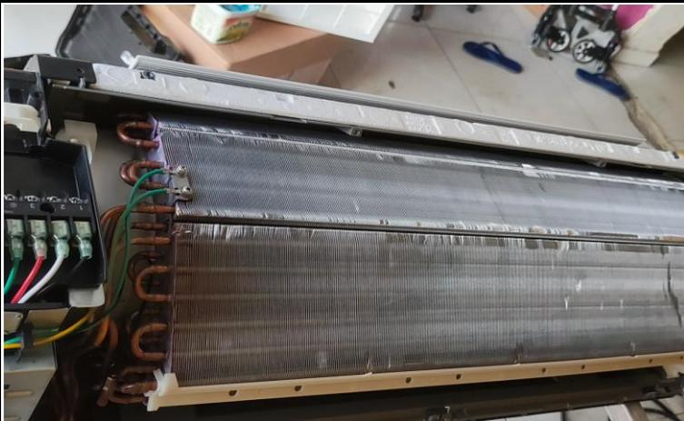
FOTO 01: MONTAGEM DA UNIDADE EVAPORADORA.
