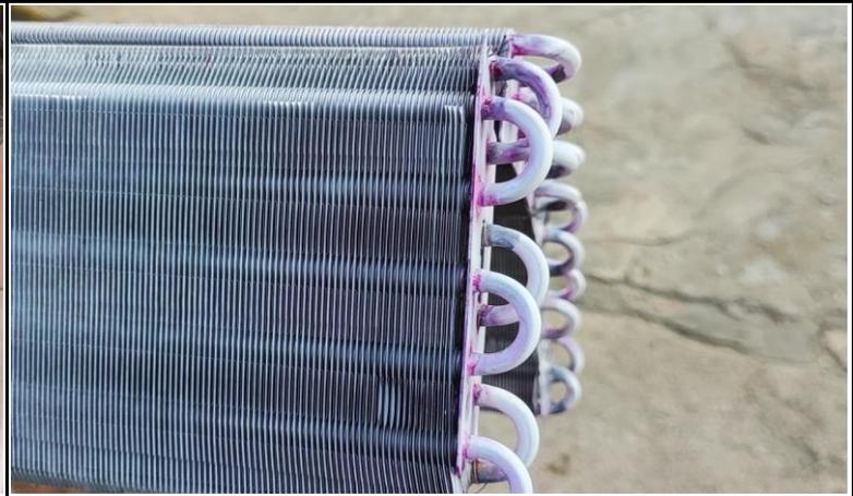
FOTO 03: APLICAÇÃO DE REVELADOR PARA VERIFICAR SE HÁ TRINCA OU FISSURAS NAS SOLDAS.
