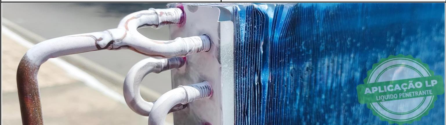
FOTO 05: APLICAÇÃO DO LIQUÍDO REVELADOR NA SERPENTINA DA UNIDADE CONDENSADORA, PARA VERIFICAÇÃO DE TRINCAS.
