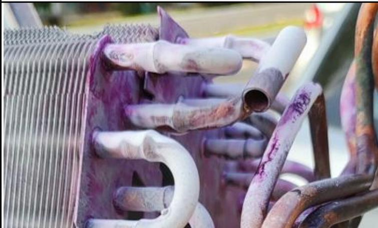
FOTO 04: APLICAÇÃO LÍQUIDO REVELADOR NA SERPENTINA DA UNIDADE EVAPORADORA.
