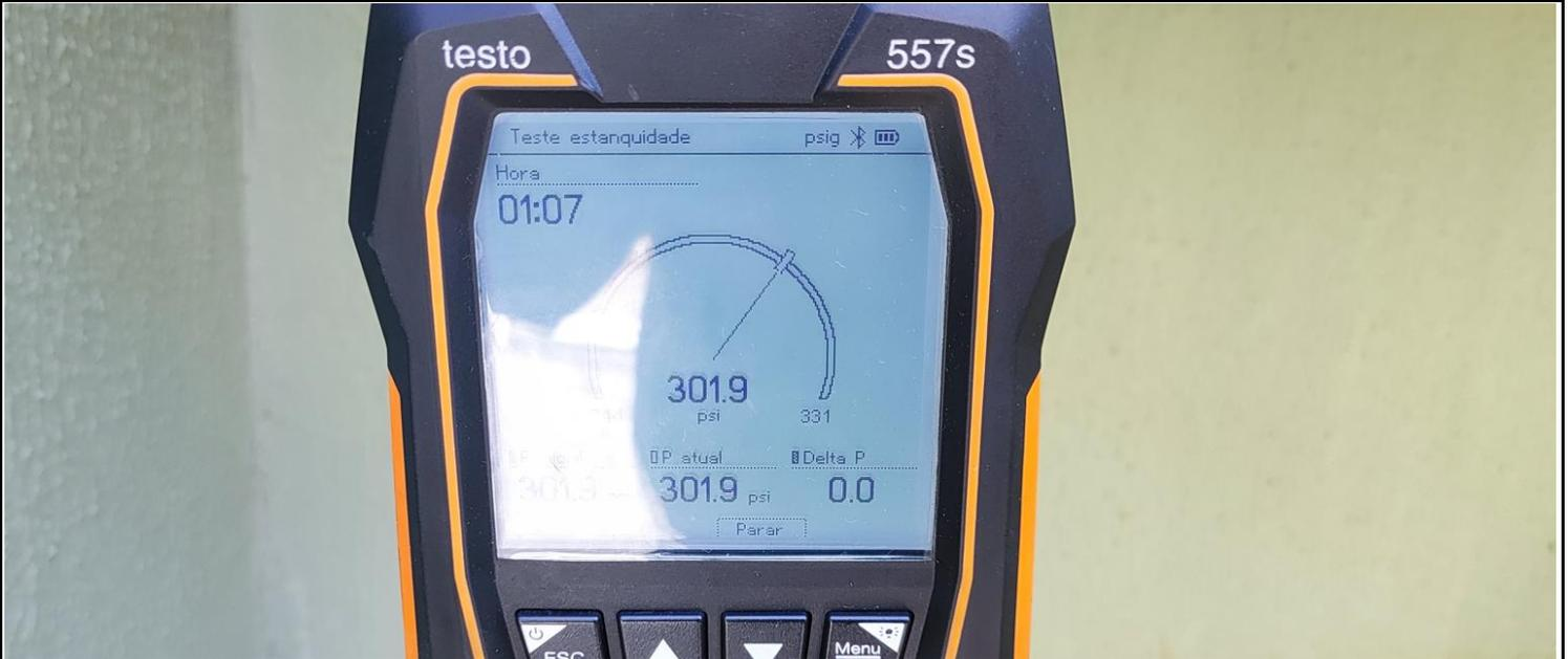
FOTO 01: CONFIRA ACIMA IMAGEM DO DISPLAY DO MANIFOLD TESTO 557s, PRESSÃO EM 301.9 PSI.
