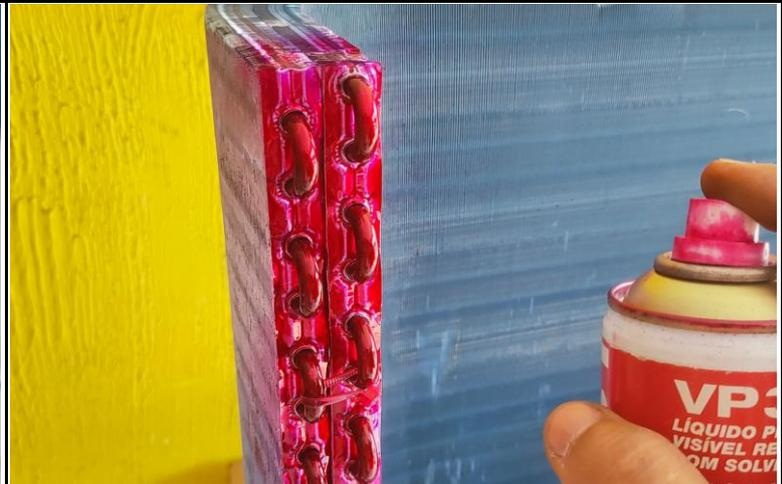
FOTO 03: APLICANDO O VP3 LÍQUIDO PENETRANTE PARA VERIFICAÇÃO DE TRINCAS, OU FRESSURAS.
