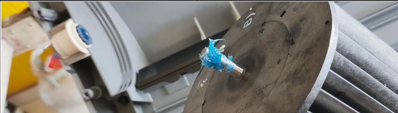
FOTO 03: APLICAÇÃO DE LUBRIFICANTE NA PONTA DO EIXO DA TURBINA E LUBRIFICAÇÃO NO MANCAL COXIM.
