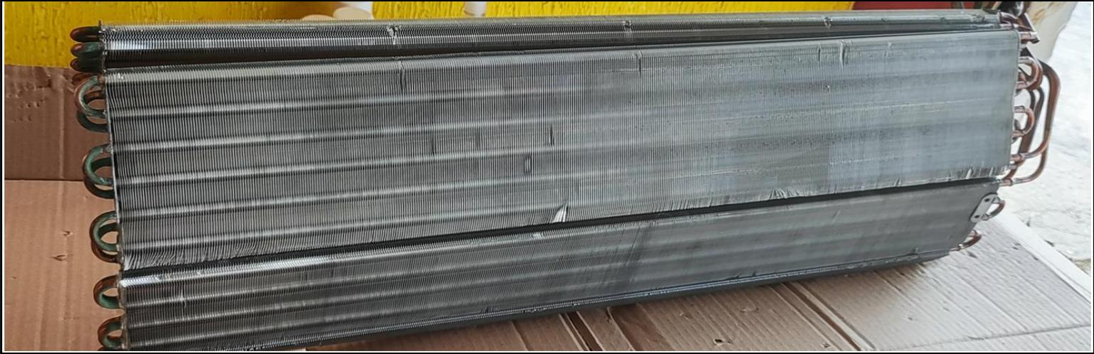
FOTO 01: SERPENTINA DA UNIDADE EVAPORADORA, HIGIENIZADA
