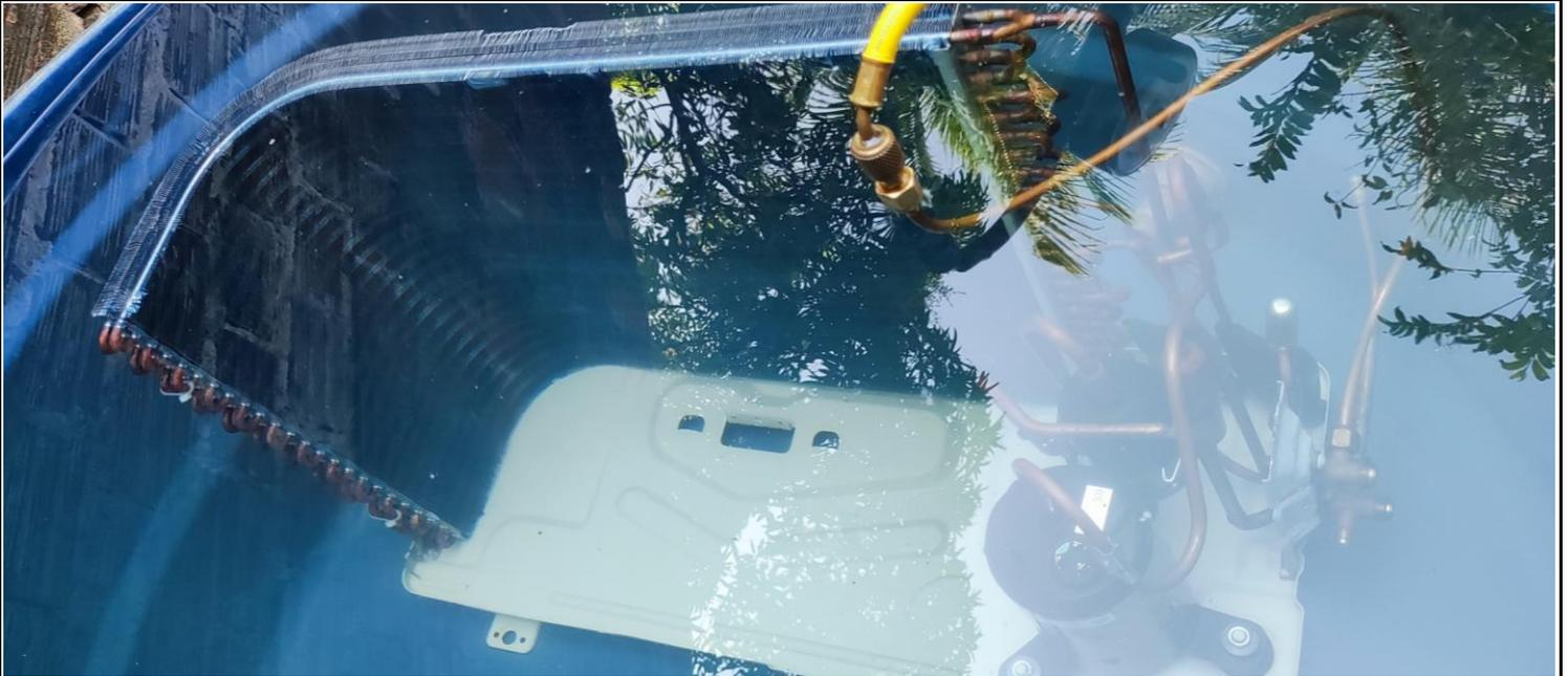
FOTO 01: UNIDADE CONDENSADORA EM RECIPIENTE SUBMERSO A ÁGUA PARA VERIFICAÇÃO DE POSSÍVEIS VAZAMENTOS
