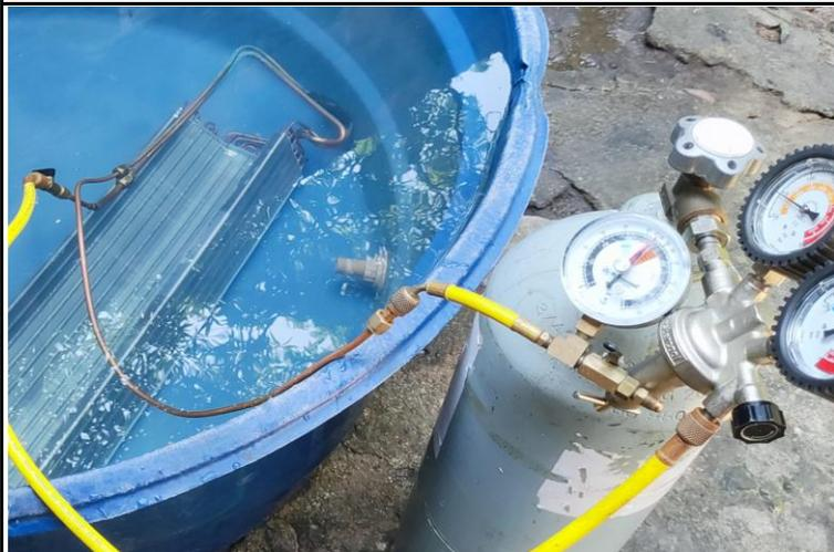
FOTO 02: VEJA COMO É EXECUTADO O TESTE DE ESTANQUEIDADE SUBMERSO COM NITROGÊNIO.
