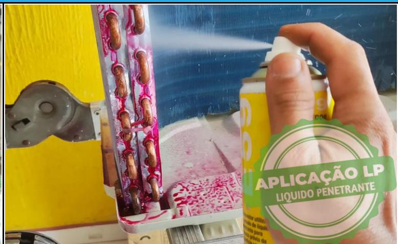
FOTO 02: APLICANDO E59 REMOVEDOR DO LÍQUIDO PENETRANTE.
